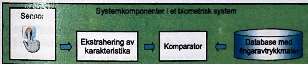
Figur 8.12. Generelle komponenter for et biometrisk system.
