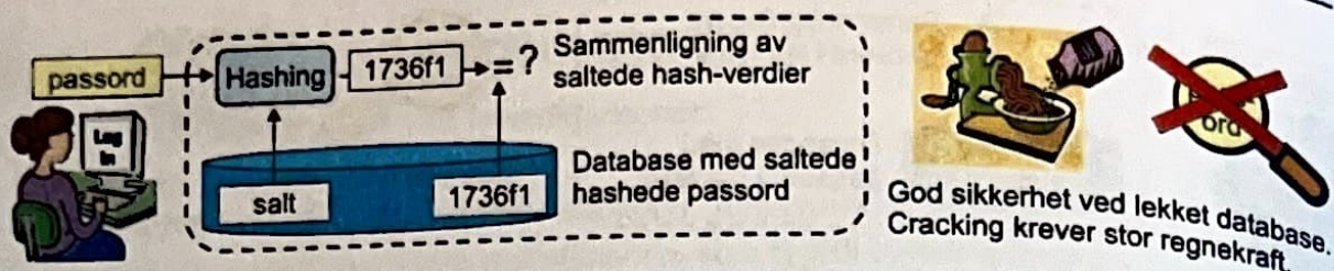
Figur 8.3. Sjekking av passord lagret som saltet hash-verdi, som gir god sikkerhet i tilfelle lekket database.
